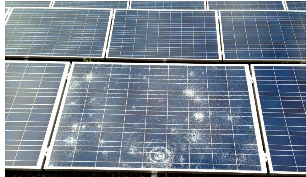
Beispiel: Minderwertiges Fernost-Modul nach Hagelschauer
